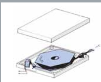
Fig. 1 - Rivelatore di movimento a filo.
